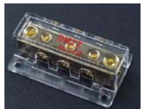
23429 Распределительный блок 2-3. Входы: 2 x 35 ... 70 мм 2 , выходы: 3 x 20 мм 2 .
