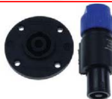
30400 Разъем Speakon — набор для 4- контактной версии с системой быстрого запираания «Quick Lock», вилка и розетка. Для кабелей сечением максимум 4,0 мм 2 .
