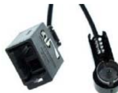
662 Экономичный RCA фильтр помех. Фильтрация на основе гальванической развязки. Трансформаторы фильтруют шумы от паразитных контуров заземления.
