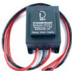
442 Фильтр электропитания 40/120 А. LC-фильтр электропитания на 40 А (пиковая мощность 120 А) с высокомоощным трансформатором и большей емкостью конденсаторов. Подавляет шумы источника электропитания и генератора. Только для автомобилей с электрооборудованием 12 В.
