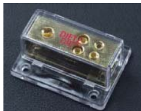
23405 Распределительный блок 1-4. Вход: 20 мм 2 , выходы: 4 x 6 ... 10 мм 2 .
