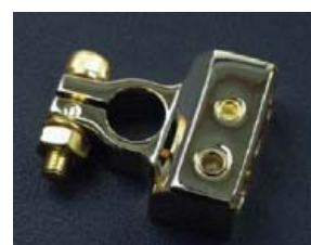
23455 Клемма для минусового вывода аккумулятора, позолоченная. Выходы: 50 мм 2 , 20/35 мм 2 , 2 x 10 мм 2 .
