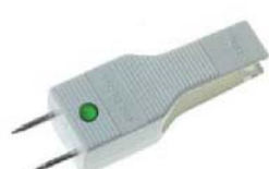
23302 Устройство для проверки предох- ранителей АТС. Проверка заключается в простой вставке устройства в отверстия в головках предохранителя. При неис- правности предохранителя зажига- ется светодиод.
