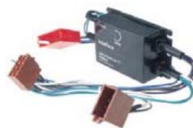
17005 Интерфейс MINI ISO, для активных и полуактивных аудиосистем. Интерфейс для полностью или частично активных аудиосистем AUDI серии A, TT, PORSCHE 996, BOXTER, VW-GOLF DSP (начиная с 04/98) и PASSAT DSP, BOXST с пассивными фронтальными и активными тыловыми громкоговорителями, обеспечивающий подключение нового головного устройства с максимальной мощностью 4 x 50 Вт. Подходит также для систем BOSE автомобилей AUDI.
