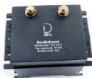
444 Сетевой фильтр 75/160 А. L-фильтр электропитания на 75 А (пиковая мощность 160 А), отвечающий также самым высоким требованиям по продолжительности работы. Рассчитан на подключение кабеля 70 мм к винтовым клеммам М8. Подавляет шумы источника электропитания и генератора.
