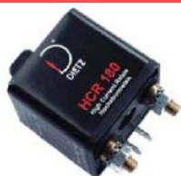
22018 Реле сильного тока HCR 180. Реле коммутирует долговременный ток 150 А и пиковый ток 180 А. Предназначено для отключения аккумулятора при остановке автомобиля.
