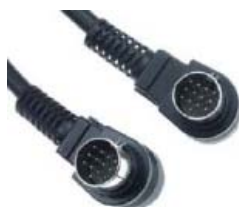
PC7-4400 5-метровый кабель CD-чейнджера для PHILIPS. Переходник на 8-контактный разъем DIN с 10-контактного разъема MINI ISO.
