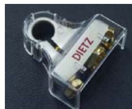
25455 Минусовая клемма с платиновым покрытием для аккумулятора. В комплекте — защитная крышка. Входы: 50 мм 2 , 20 мм 2 , 2 x 6/10 мм 2 . Компрессионный зажим для лучшего контакта с проводом.
