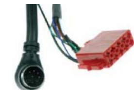
PC7-4400 5-метровый кабель CD-чейнджера для PHILIPS. Переходник на 8-контактный разъем DIN с 10-контактного разъема MINI ISO.
