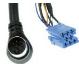
PC7-4401 5-метровый кабель CD-чейнджера для PHILIPS. Переходник на 8-контактный разъем DIN с синего разъема MINI ISO, например, для RC 026.
