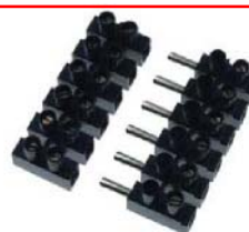
30412 Стыковой соединитель со штырями, 6-ти контактный, для кабелей сечением максимум 2,5 мм 2 .
