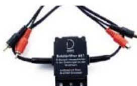
661 RCA фильтр помех 20 Гц ... 40 кГц. Основан на том же принципе, что и 660, но построен на высококачественном трансформаторе. Трансформаторы фильтруют шумы от паразитных контуров заземления.
