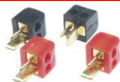
23061 Штекер DIN для акустических систем. 1 пара красных и 1 пара черных. Для кабелей сечением до 2,5 мм 2 .
