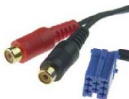
1301 Адаптер входа AUX для разъема MINI ISO BECKER-BLAUPUNKT. Адаптер для подключения к головным устройствам BECKER или BLAUPUNKT со входом AUX на разъеме MINI ISO портативных аудиоустройств, например, дискменов, MP3-плееров и т.п. Не совместим с головными устройствами заводской установки и DAB 53, DAB 52.
