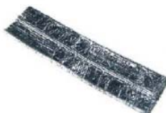
30300 Покрывающая алюминием стекловолонная трубка для предохранения кабелей от перегрева вблизи мотора. Усиленная защита SAE J2302, неабразивная. Для кабелей до 70 мм².
