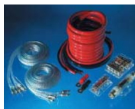
23095 Комплект кабелей под 50 мм 2 . Держатель для предохранителя ANL 100 А; кабель питания 5 м, красный; 1 м, черный, 10 мм 2 , 2 м красный, 2 м черный; блок предохранителей 1-4 (30/60 А); блок распределения заземления; 2 x 5 м кабель RCA NASHVILLE; 2 предохранителя AGU — на 30 А и 60 А; 16 различных клемм.
