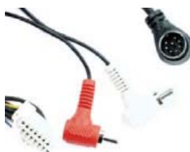
PC7-4771 5-метровый кабель CD-чейнджера для PANASONIC. Переходник на 8-контактный разъем DIN с 16-контактного разъема (белый) для следующих моделей CD-чейнджеров: CX-DP 9060/61, 801/803, 88N, 1212.
